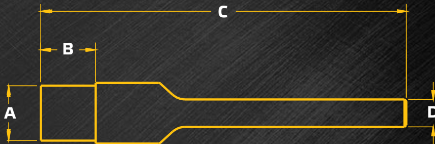
(A) Diameter (B) Trim Length (C) OAL (D) Shank Diameter
